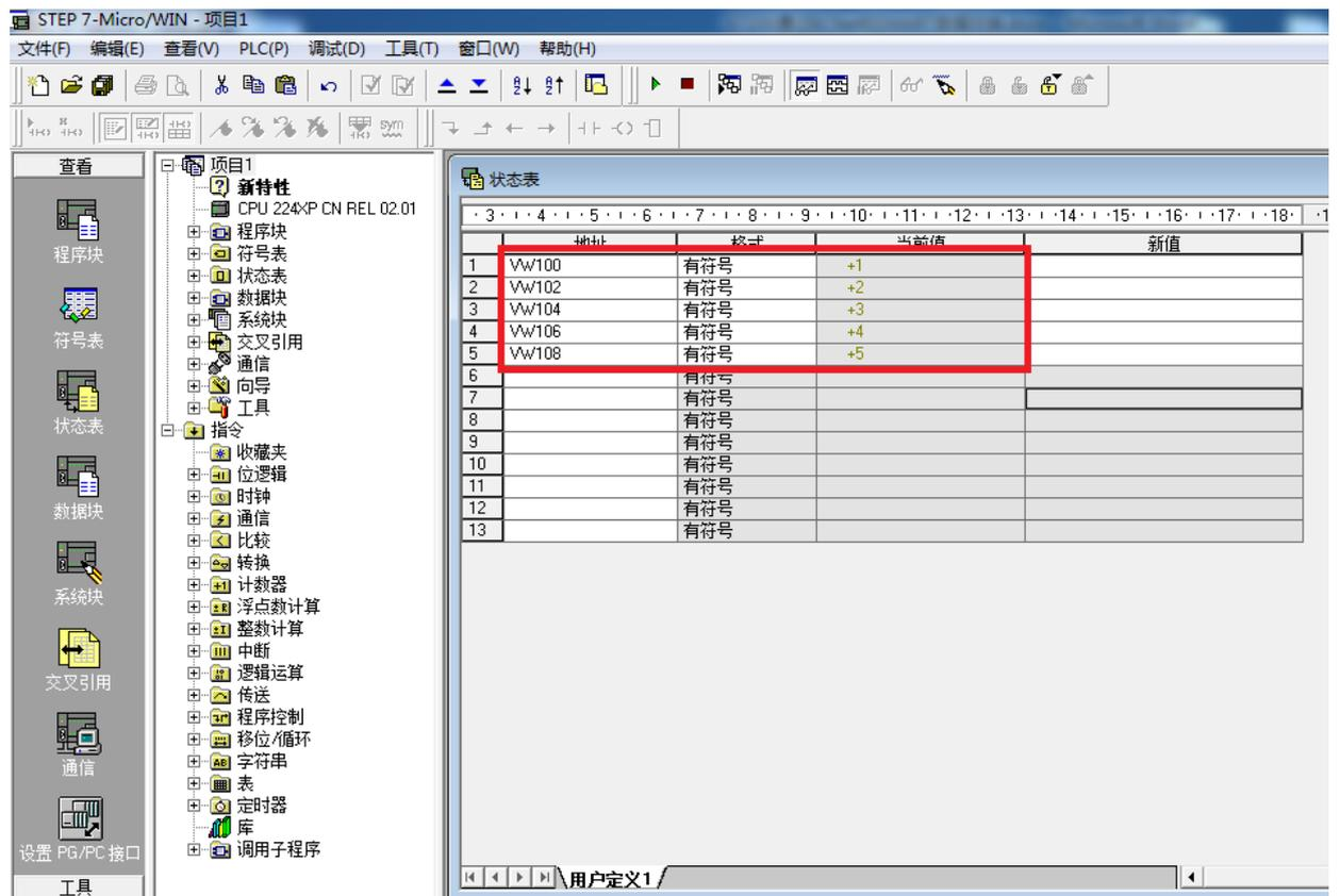
2、打开 STEP7-Micro/WIN SMART200 的状态表，对 VW100~VW108 进行数据监视；
